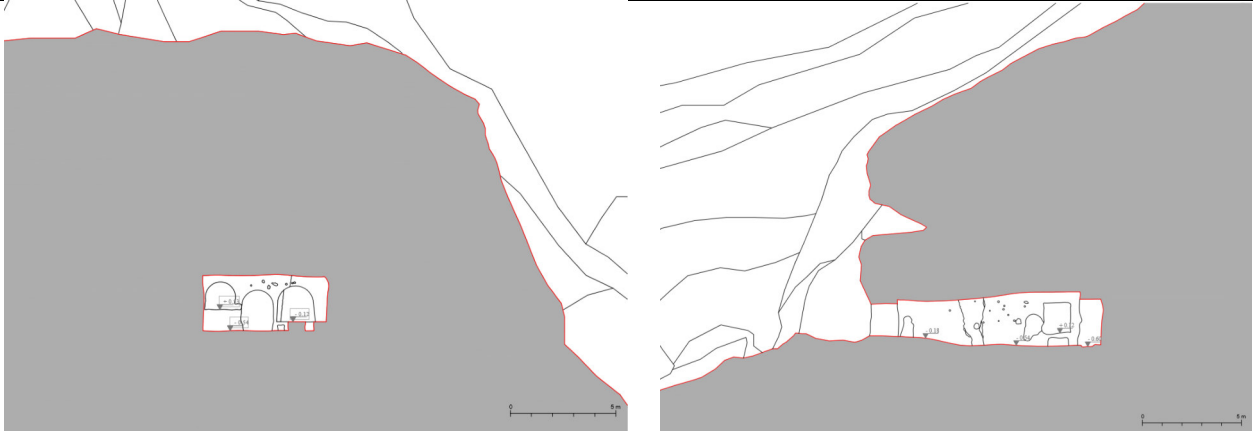
Şekil 29. Göreme 2F, Yemekhane A-A ve B-B Kesit Rölövesi (Ertürk, 2020)
