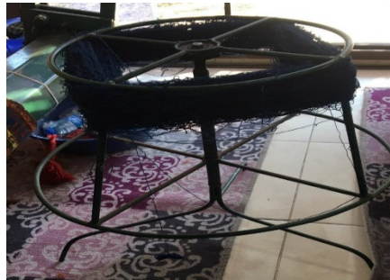
Fotoğraf 21. Boyanan ip gelep aparatında sarılması (Kılıç Karatay,2020).
