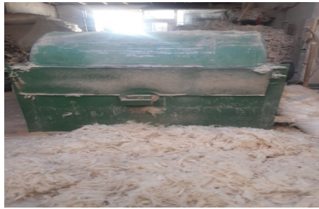
Fotoğraf 18. Yünlerin çırpma makinesinde çırpılması (Kılıç Karatay,2020).
