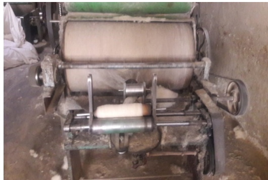
Fotoğraf 6. Tarak Makinesi ön söme yapan kısmı(Kılıç Karatay,2020).
