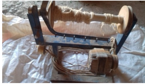
Fotoğraf 8. Elektrik ile çalışan çıkırık örneği(Kılıç Karatay,2020).
