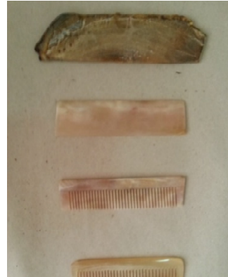
Fotoğraf11. Boynuzun Tarağa Dönüşüm Aşamaları
