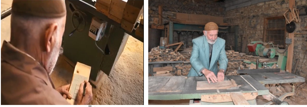
Fotoğraf 8. Ölçüye Göre Yatay Daire Testere Kesme işlemi.
