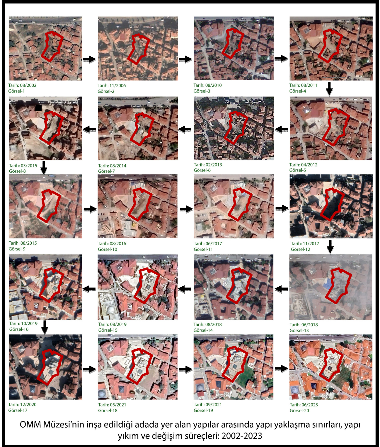
Şekil 5: OMM Müzesi'nin inşa edildiği adada yer alan yapılar arasında yapı yaklaşma sınırları, yapı yıkım ve değişim süreçleri: 2002-2023 11 (Kırmızı: OMM Müzesi parsel sınırları).
