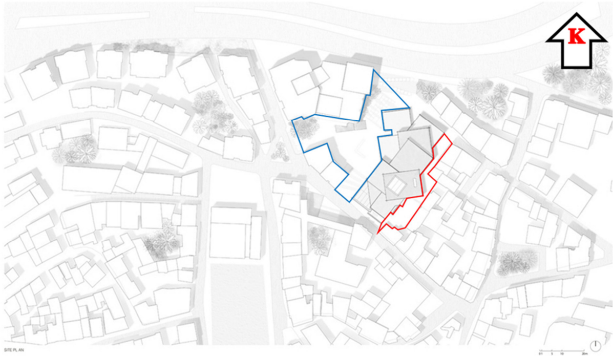
Şekil 8: OMM Müzesi vaziyet planı (Kengo Kuma and Associates, 2023a) (Kırmızı: Müzenin güney-doğusunda kalan yapılar ile aralarındaki mesafe ve yapı yaklaşma sınırları; mavi: müzenin kuzey-batısında kalan yapılar ile aralarındaki mesafe ve yapılaşma sınırları).
